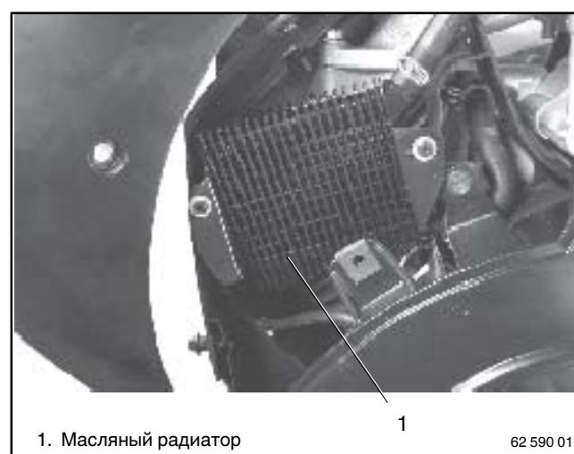
**Рис. 4-3** Место установки масляного радиатора
