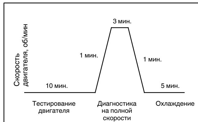
Рис. 2-2 Цикл тестирования без нагрузки
